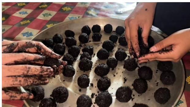
Gambar 7. Proses pembentukan briket menggunakan tangan
